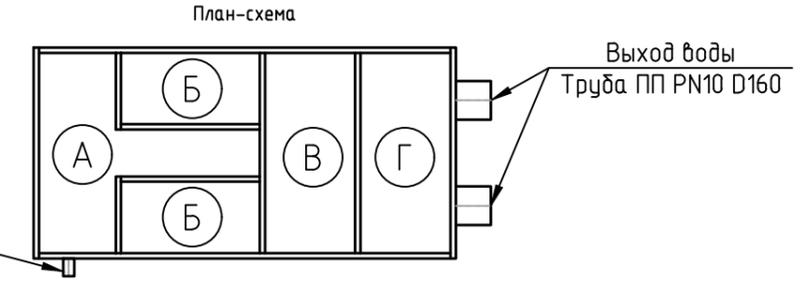
Секция А – Секция бактерицидной УФ установки и компрессора; Секция Б – Секция механической и анаэробной биологической очистки воды (анаэробный реактор с закрепленной микрофлорой); Секция В – Секция аэробной биологической очистки с плавающей загрузкой; Секция Г – Секция физико-химической очистки воды (цеолитовая загрузка).
